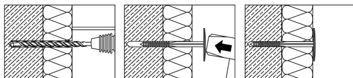
1. Erstellen des Bohrloches 8 mm
